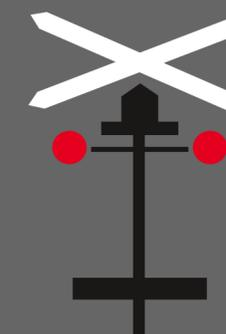
**Luz intermitente roja** de la señal ferroviaria significa **PASO A NIVEL o descenso de barrera**
